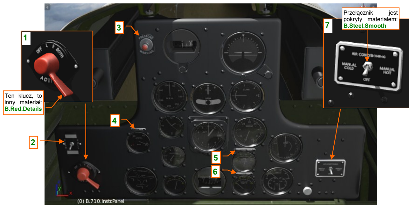
Rysunek 2.6.21 Tablica przyrządów, uzupełniona o pozostałe szczegóły
