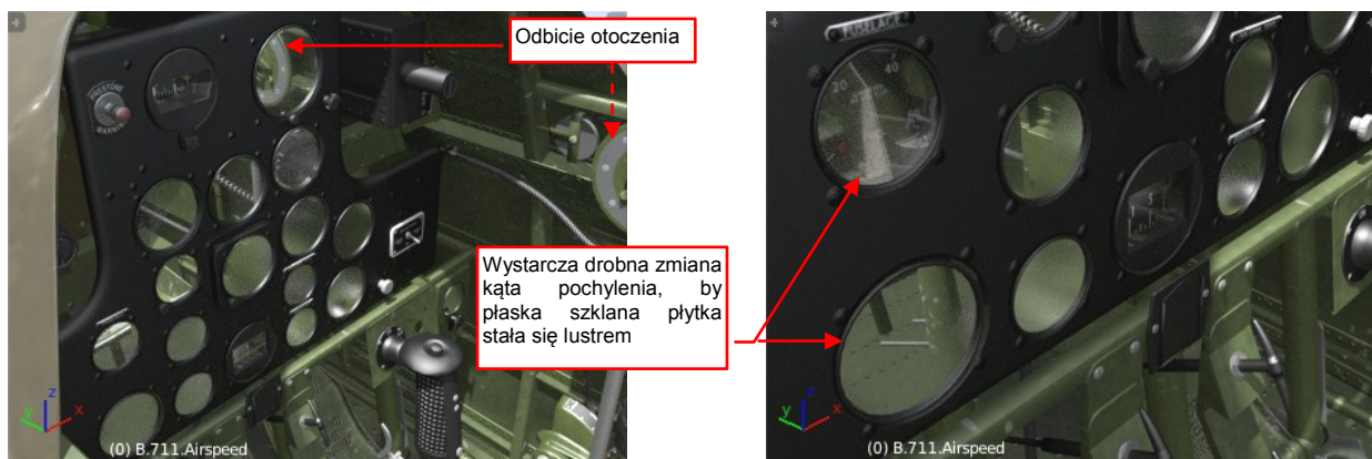
Rysunek 9.13.15 „Lustrzane” odbicia otoczenia w osłonach przyrządów pokładowych
