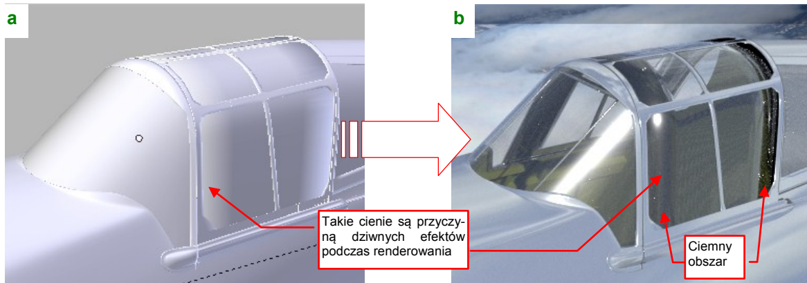
Rysunek 8.14.3 Efekt ostrej krawędzi oszklenia powierzchni i cieniowania Shade Smooth na renderze
