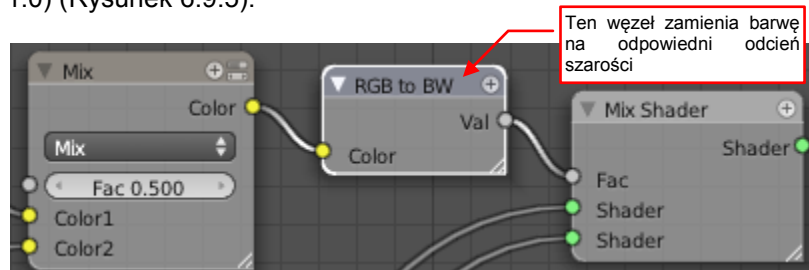
Rysunek 6.9.5 Przykład jawnej konwersji typu połączenia (tutaj: z barwy na liczbę)
