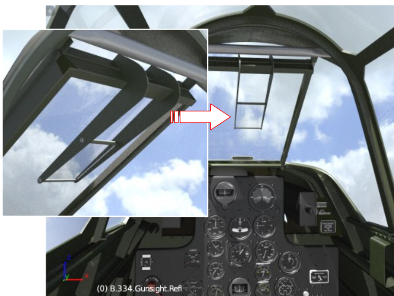
Rysunek 2.6.25 Reflektor celownika, dorabiany dla samolotów AVG
